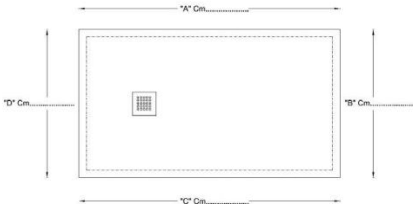
Le parti interessate dal taglio devono necessariamente aderire alle pareti / The cut side must be installed against the wall.
